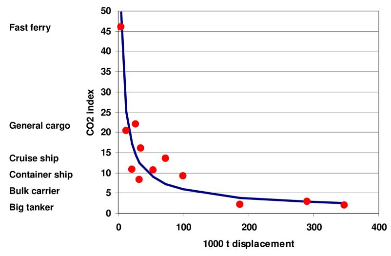
Mean value curve  $I_m = a/(Displacement)^b$
